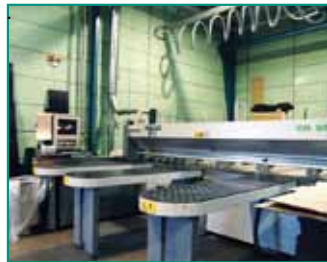
SELCO EB 95 mm såg (faner / trä / plast) 3,8 x 3,2 m x 80 mm med optimering
