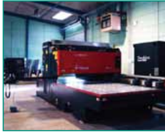
AMADA laserskärare 4 KW 1500 x 5000 x 12 mm
