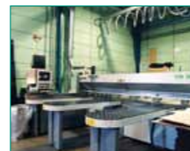
SELCO EB 95mm såg (fanér/trä/plast) 3,8 x 3,2m x 80mm med optimering.
