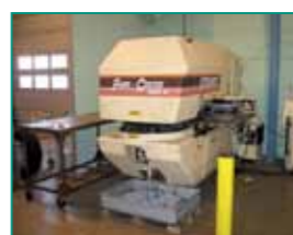
Robotstans FABRI-CENTER Stanseffekt: 20 ton.
