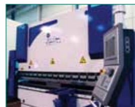
ITALTEC kantpress, 160 ton/3 m.
