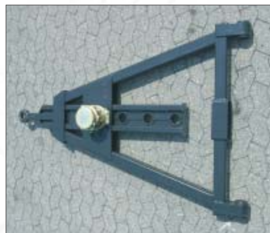
Luftaktiveret triangel med justerbar længde. D-værdi 190. Vægt ca. 100 kg.
