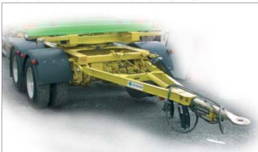
Boltet triangel med justerbar længde, D-værdi 190
